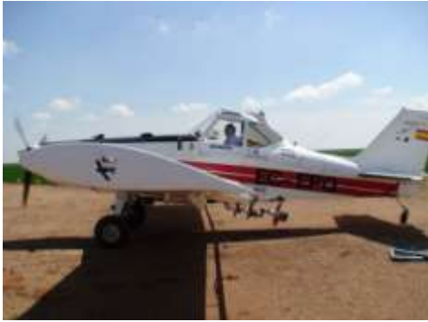
Avioneta para usos agrícolas utilizada en el tratamiento y detalle de Atomizadores ULV dispuestos en el ala de la avioneta.
