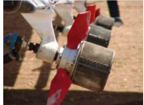
Avioneta para usos agrícolas utilizada en el tratamiento y detalle de Atomizadores ULV dispuestos en el ala de la avioneta.
